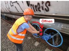
Die beladenen Waggons lassen sich nur schwer öffnen, da die Abmessung der Entladeklappen viel größer ist als bei kleineren Waggons und das gesamte Gewicht der Ware auf diesen Entladeklappen liegt, so dass der Druck beim Öffnen erheblich ist.
