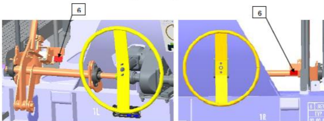
Abb. 6 – Stellung des Anzeigers (6) bei geöffnetem Dach
